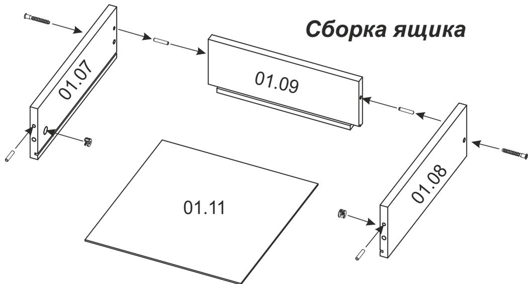
Установите шканты 6x30 в отверстия на торцах боковых и задней стенках ящика, эксцентрики на боковые стенки ящика. Соедините боковые и заднюю стенки ящика, скрепите их евровинтами и установите заглушки. В пазы на боковых и задней стенках установите дно ящика.
