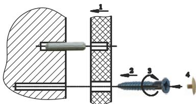
Шканты необходимо устанавливать в отверстия на кромке щитовых деталей при помощи молотка.
