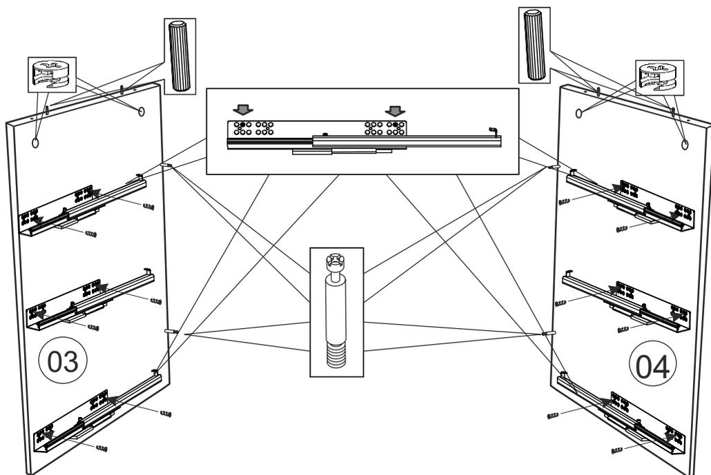
В отверстия на пласти вертикальных стенок 03 и 04 установить по 2 соединительных винта, по 2 эксцентрика и по 2 шканта 8x30.
